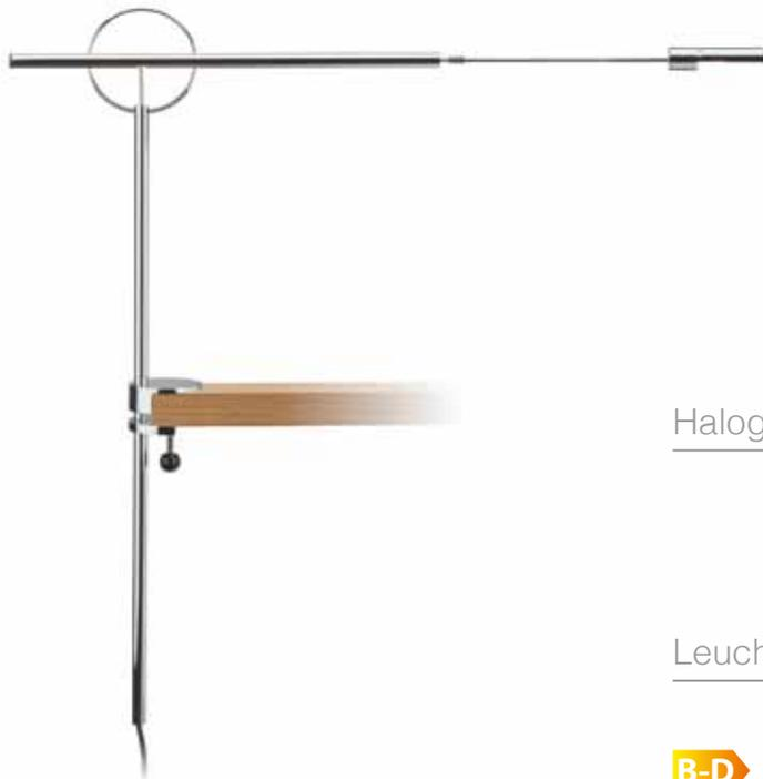
Klemmleuchte, dreh-, schwenk- und höhenverstellbar. Länglicher Reflektor. Klemme bis max. 33 mm Plattenstärke. Fassung G 6,35. Zuleitung 2800 mm, Leuchtenhöhe 700 mm, Ausladung 750 mm.
